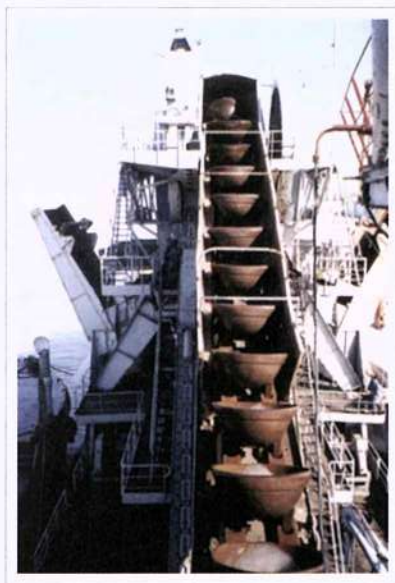
Figura II-3 - Escala de uma draga de alcatruzes.
