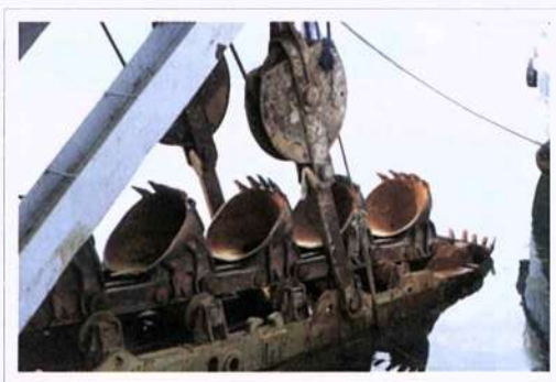
Figura II-4 - Alcatruz para dragar em zonas com presença de materiais rochosos.
