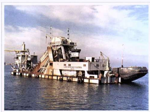
Figura II-2 - Draga de alcatruzes (foto: Luis Sánchez Guerra, FPS Dragados).
