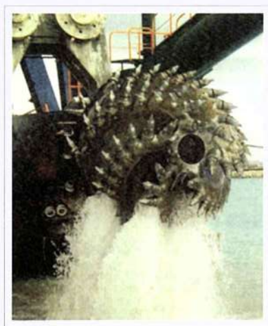
Figura II-30 - Imagem ilustrativa do cortador utilizado nas dragas do tipo cutter .
