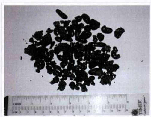
Figura V-39 - Agregados leves produzidos por processamento de materiais dragados (AZoM, 2004).
