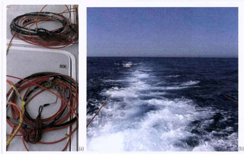
Figura III-17 · Sistemas Sparker . (a) Dois streamers de hidrofones utilizados como receptores dos sinais sísmicos; (b) Exemplo de configuração de reboque à ré de um sistema deste tipo: catamaran do Sparker a estibordo e dois streamers de hidrofones a bombordo.
