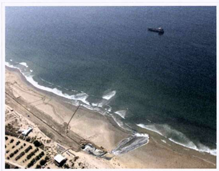
Figura V-15 · Alimentação das praias da Costa de Caparica com draga fundeada a repulsar para a praia através de um pipeline submerso.
