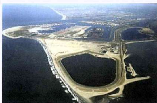
Figura I-8 Maior depósito de dragados do mundo, situado à entrada do Porto de Roterdão, com uma capacidade de cerca de 150 milhões de m^3 .
