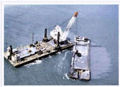
Figura II-19 - Caçamba de mandíbulas a descarregar o material num batelão.
