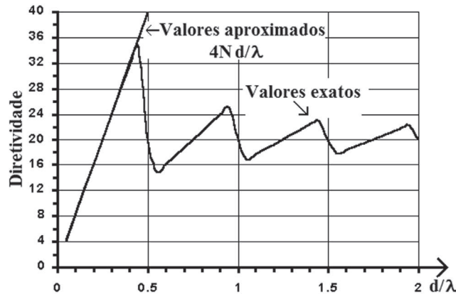
Figura 4.9 Diretividade do FA dum agregado longitudinal com 20 elementos, em função da distância d entre elementos.
