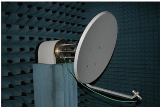
(a) Antena montada na câmara anecoica da UA
