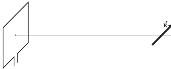
Figura 2.55 Polarização do campo radiado por um aro quadrado com um perímetro de 1\lambda .
