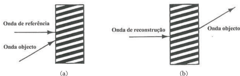
Figura 7.7 – Representação das fases (a) de registo de um holograma espesso e (b) de reconstrução da onda objecto a partir desse holograma.
